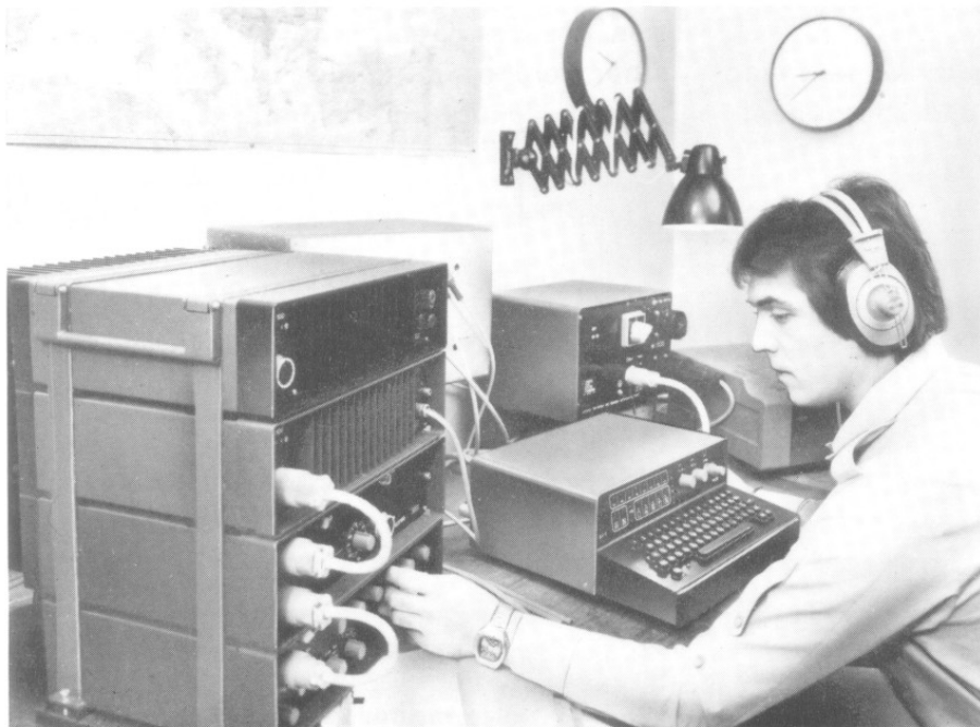
1 Automatischer Morsegeber MG 80 mit Stromversorgung SV 80 in Verbindung mit dem Sende-Empfangsgerät SEG 100 und dem Empfangsfernschreiber F 1200 im Einsatz
